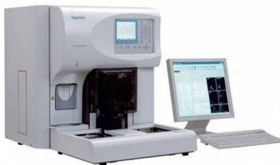
Afbeelding van een automatische celteller (Sysmex XE 5000).
